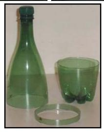
Collage de cette bague sur le culot Coca du corps de la fusée. Aligner soigneusement le dessus de la bague avec de défaut de joint du moule. Attention à la hauteur de cette bague, elle est cruciale.
