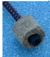
Une autre possibilité : remplacer l'aiguille par un flexible de pompe
